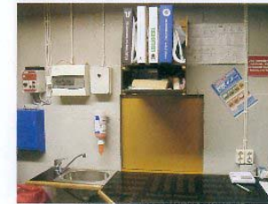
Tässä on esimerkkinen järjestely niin eläinlääkäriä kuin siementäijääkin varten. Luukku toimii työalustana ja vesipisteessä voi pestä niin kädet kuin saappaatkin. Kaikki on nostettavissa seinälle pois tieltä.
