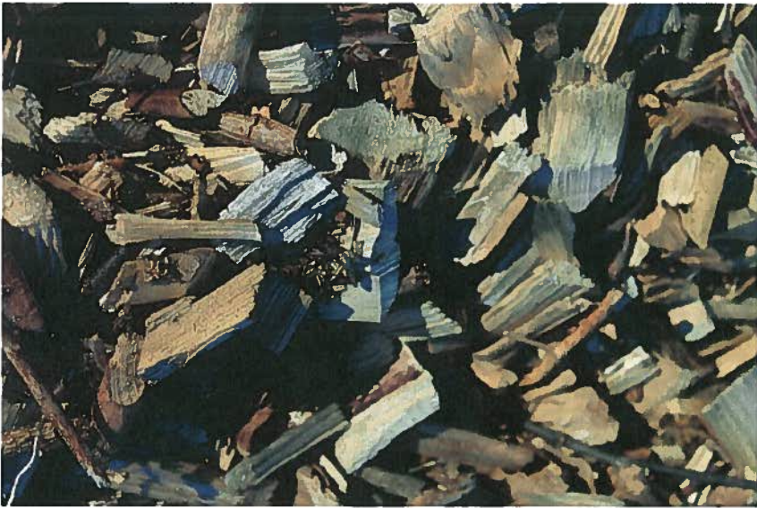
Kuva 1. Metsähakkeen palakoko on yleensä puolesta senttimetristä kolmeen, palahakkeella viisi-kymmenen senttimetriä. Kuva: Eeva Suonpera.
